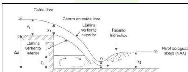
**Figura 4-2 Esquema de estructura de caída<sup>5</sup>**
