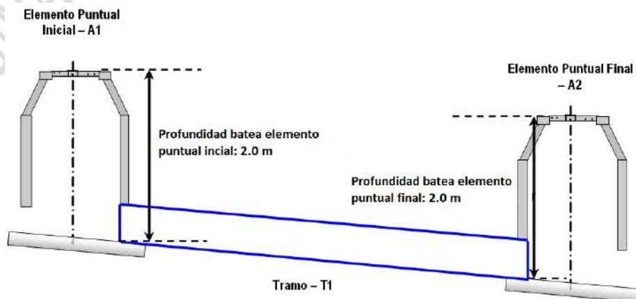
Ilustración 31. Profundidad batea de entrada y de salida.
