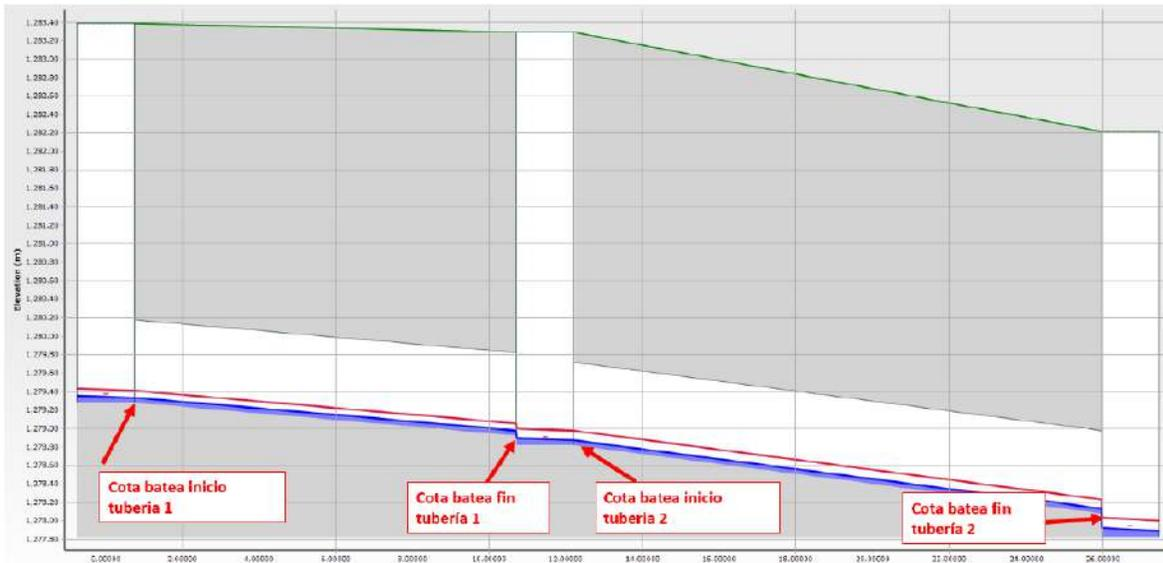
**Ilustración 66.** Vista en altura cotas aguas arriba y aguas debajo de tramo de tuberías
