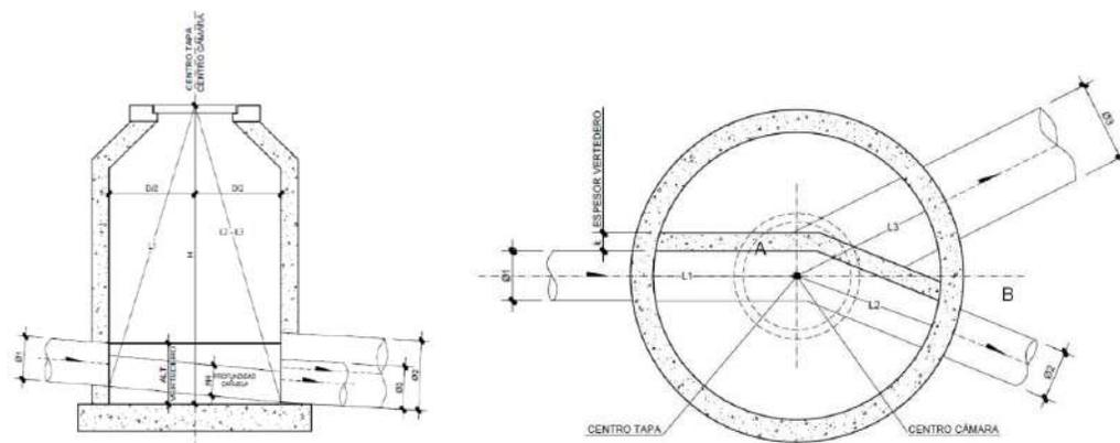
**Ilustración 48.** Planta de levantamiento de un aliviadero transversal con cañuela de fondo.
