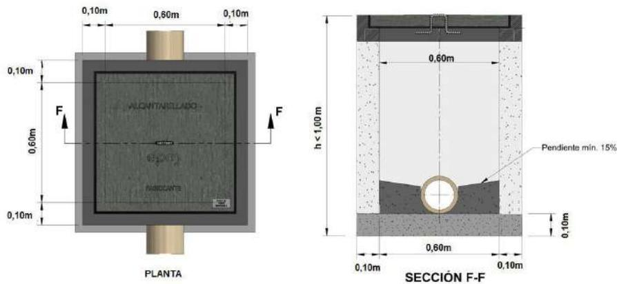
Ilustración 34. Caja de inspección– Planta y sección
