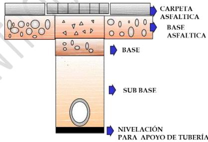
**Ilustración 28.** Instalación de tubería en zanja
