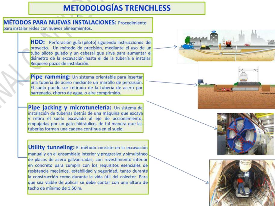
**Ilustración 21.** Métodos para nuevas instalaciones sin zanja
