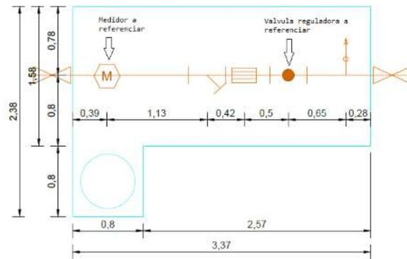
Se deben de referenciar todos los elementos constitutivos de los sistemas controladores que se encuentren al interior de la caja, igual que la válvula, nodos y tramos de tubería del baypass
