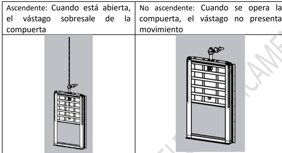
**Ilustración 38.** Tipo vástago compuerta saneamiento.
