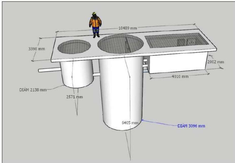
**Ilustración 61.** Planta de levantamiento de estación bombeo saneamiento.
