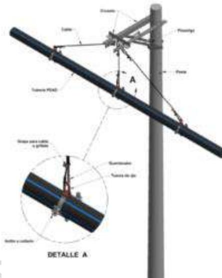
**Ilustración 32.** Tipo anclaje con guaya de acero para sistemas aéreos.
