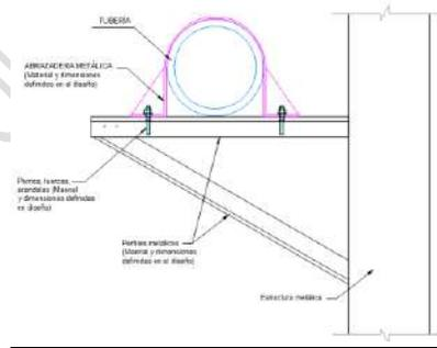
**Ilustración 25.** Fijación de tubería a estructuras metálicas
