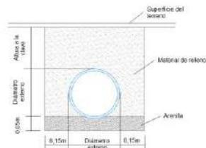
**Ilustración 29.** Instalación de tubería en zanja de alcantarillados no convencionales
