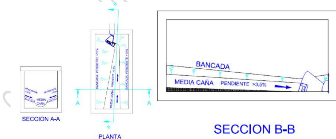
Ilustración 18. Cámara/pozo de regulación
