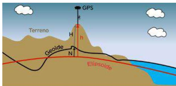
h= Altura elipsoidal H= Altura ortométrica N= Altura geoidal
