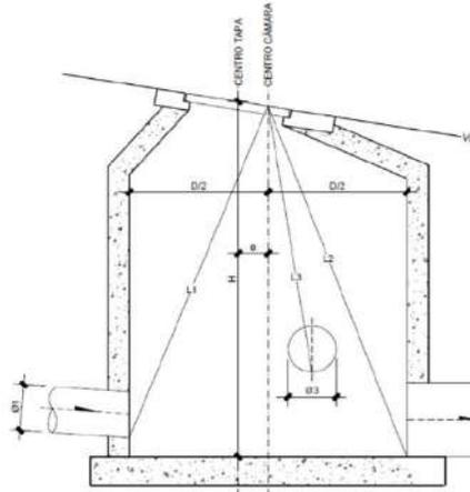
Ilustración 55. Esquema cámaras con inclinación en la tapa.
