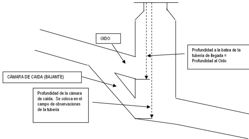
Ilustración 57. Medición profundidad cámara caída.
