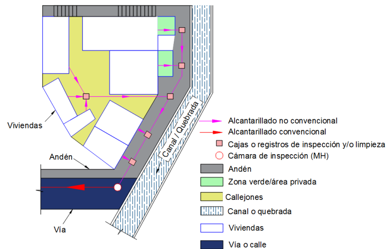
Ilustración 35. Solución de saneamiento utilizando un alcantarillado no convencional.
