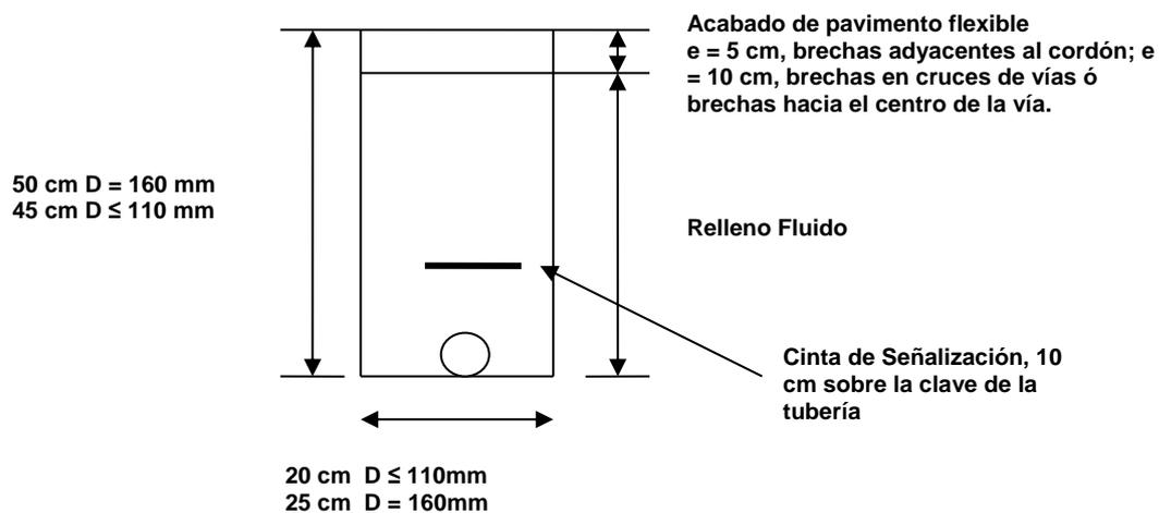
Esquema General para brechas en Pavimento Rígido
