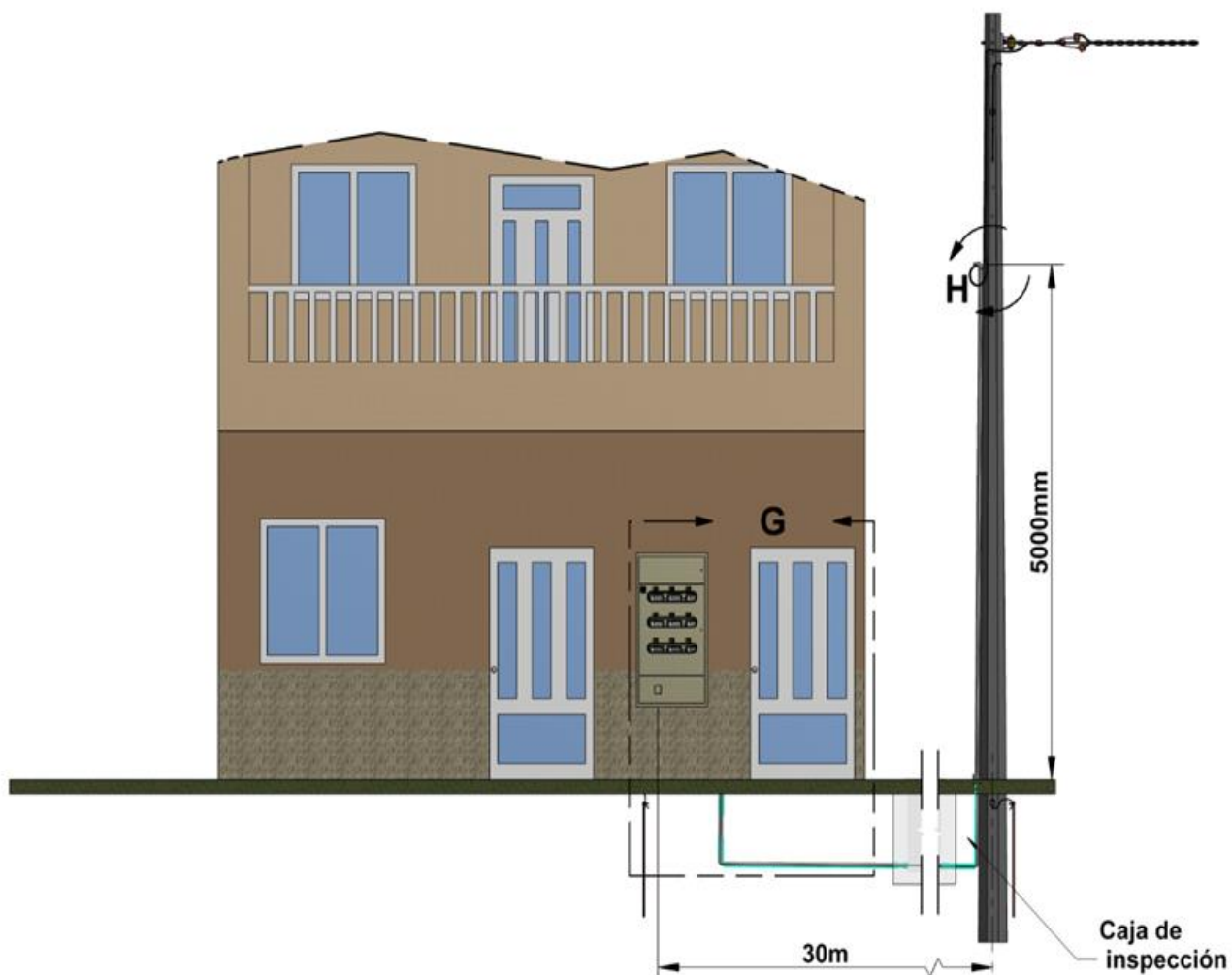
Figura 5. Acometida múltiple. Tablero para múltiples medidores de energía
