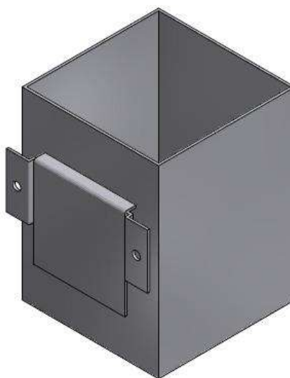
Figura 30. Soporte para de fijación para el transformador elevador.
