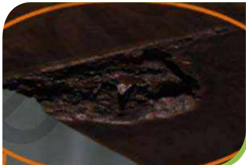
**Imagen 1.** Deterioro del cobre por corto circuito entre espiras. Tomada de (M&M Bobinados Industriales, 2016).
