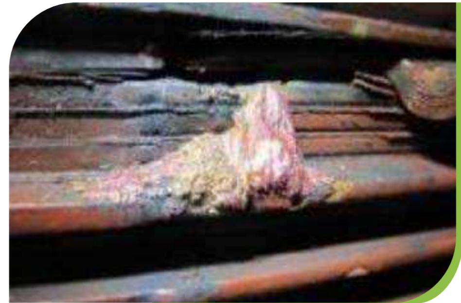
**Imagen 2.** Defecto de soldadura en las secciones que conforman las espiras de las bobinas en uno de los polos de la Unidad 5 de la central hidroeléctrica Guatapé. Tomada de (M&M Bobinados Industriales, 2016).
