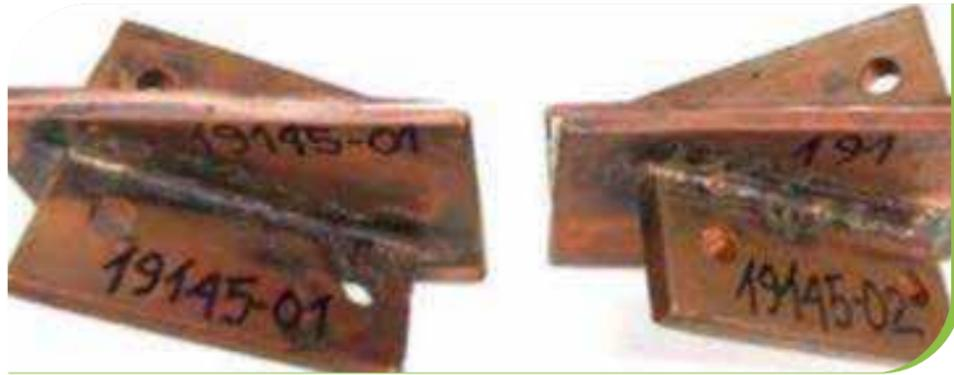
**Imagen 9.** Probetas para el esfuerzo de cizalladura y de empuje.
