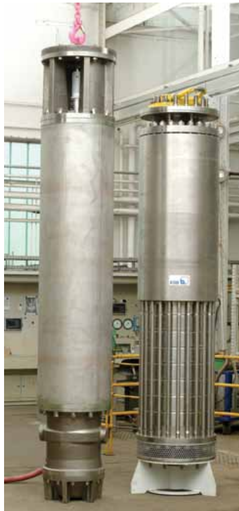
Bomba tipo lapicero con motor sumergido (KSB).
