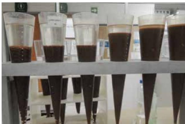
**Imagen 2.** Ensayo de sólidos sedimentables
