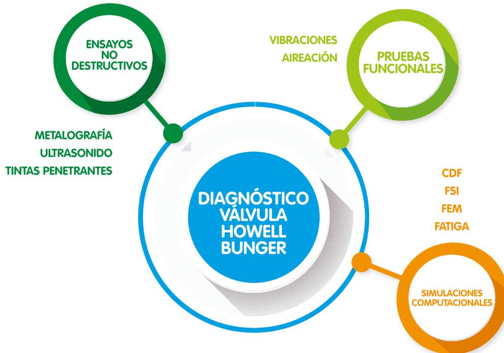
**Figura 1.** Pruebas diagnósticas implementadas en el análisis del estado de la válvula Howell Bunger
