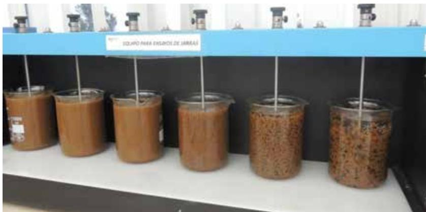
**Imagen 1.** Acondicionamiento y mezcla rápida de los lodos
