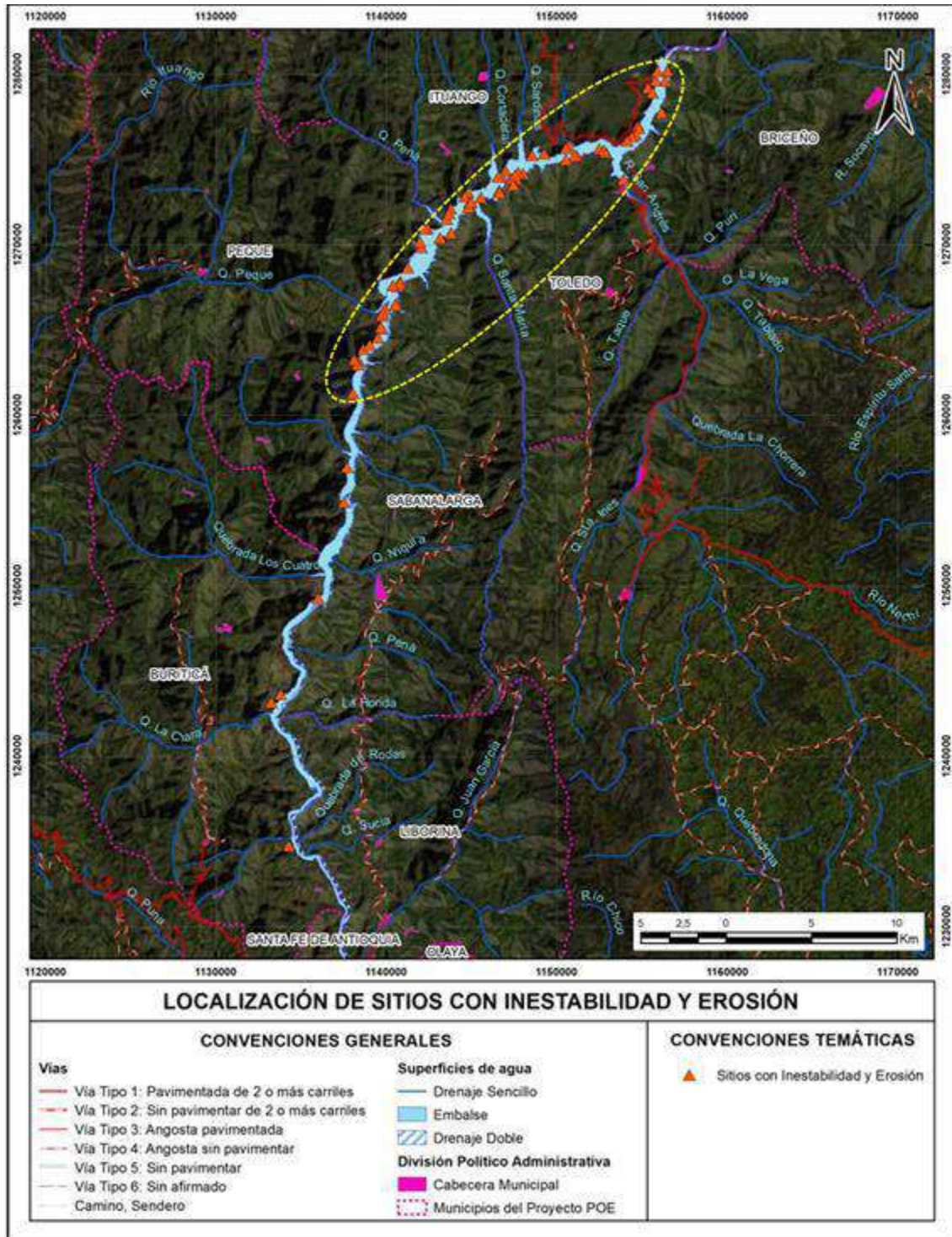
Figura 128. Sitios con inestabilidad y erosión en las laderas del embalse (zonas más críticas encerrada en líneas discontinuas de color amarillo)
