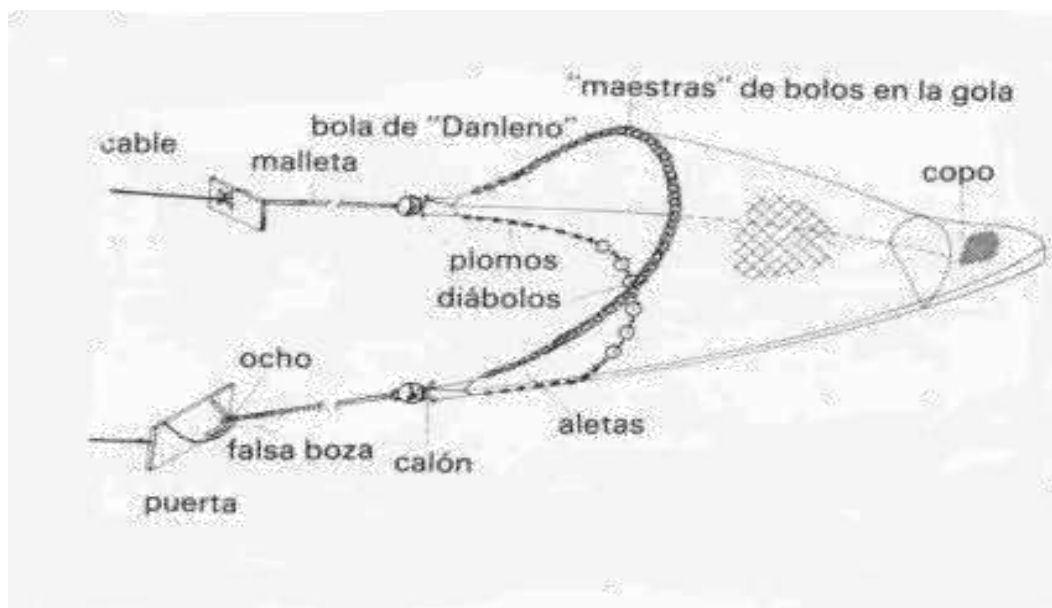
Figura 46. Esquema de redes de arrastre
