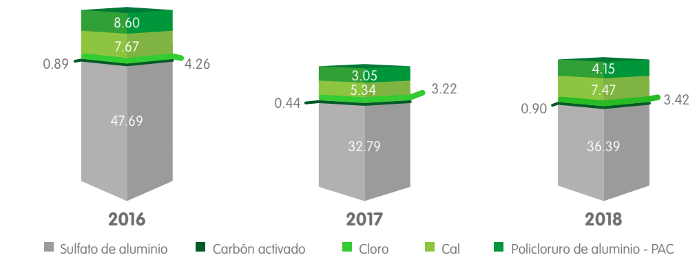
Insumos utilizados en la potabilización del agua - Grupo EPM (t/Mm 3 )
