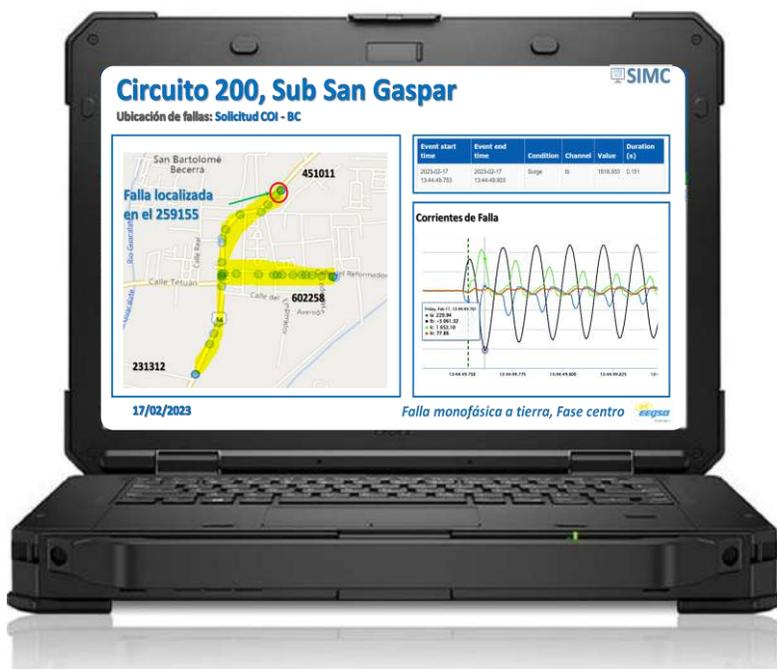
Es una plataforma tecnológica para el monitoreo de la calidad del servicio de la distribución (*Voltage Quality Monitoring –VQM-*) de forma masiva, automatizada y en tiempo real basada en la integración de analizadores de calidad de energía, complementada con modelos de gestión y explotación de datos desde la perspectiva de Inteligencia de Negocios.
