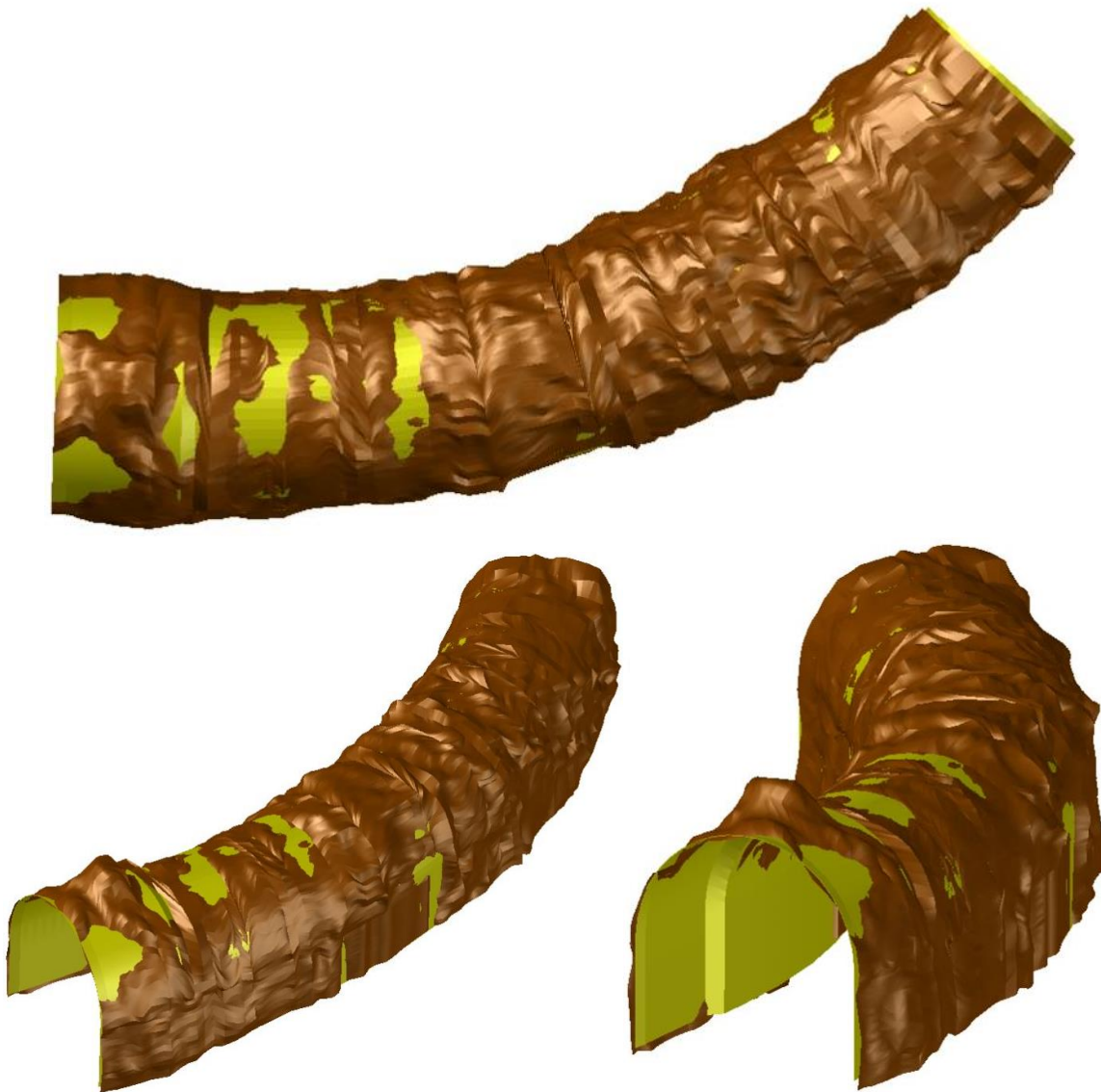
Figura 20 Visualización CAD del perfil final del túnel en la zona de la curva de la GAD.
