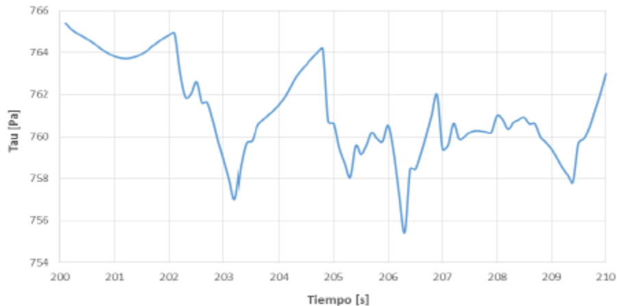
Figura 28 Variación temporal del esfuerzo de corte en régimen estable.
