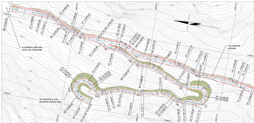
Figura 2-12 Vía de acceso para la aplicación del tratamiento de control de erosión.
