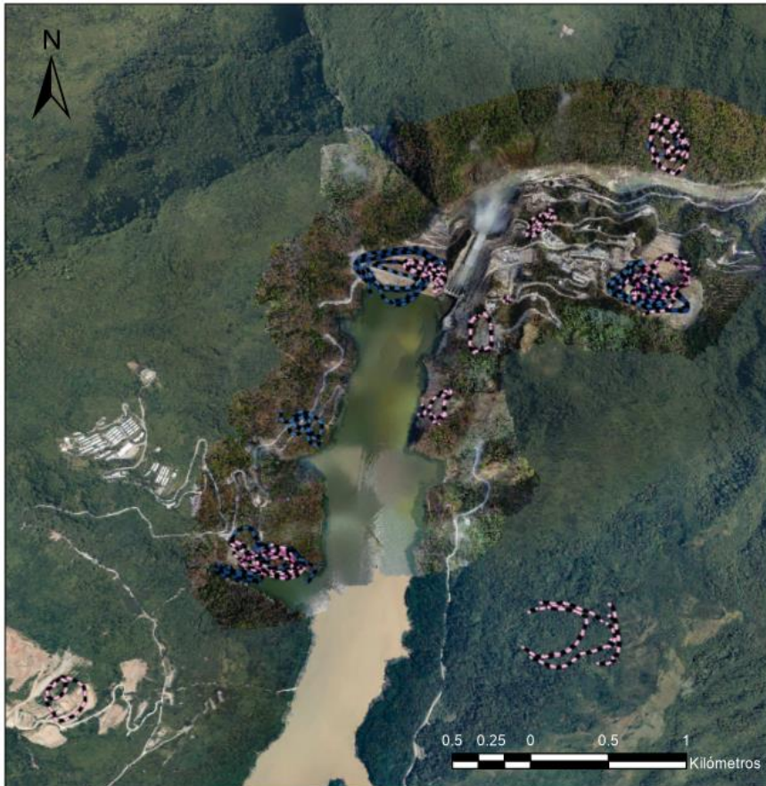
Figura 2-96. Contornos de desplazamiento registrados en los diferentes frentes a partir de la técnica InSAR. RR – Línea de visión derecha (en azul) y RL – Línea de visión izquierda (en rosado).
