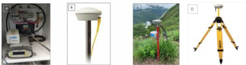
Figura 2-87. Imágenes de referencia de los instrumentos GNSS utilizados para el monitoreo. (A) Receptor GNSS Trimble NETR9 (B) Antena Trimble. (C) Receptor GNSS NavStar FLP100 (D) GNSS móvil armado sobre el trípode para la captura de datos
