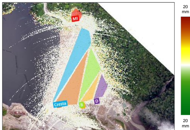
Figura 2-62. Visual de deformaciones radar SSR410 - SARX.
