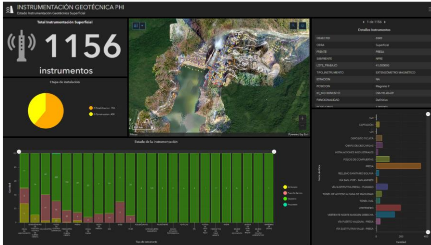
Figura 2-103. Tablero de instrumentación geotécnica superficial.
