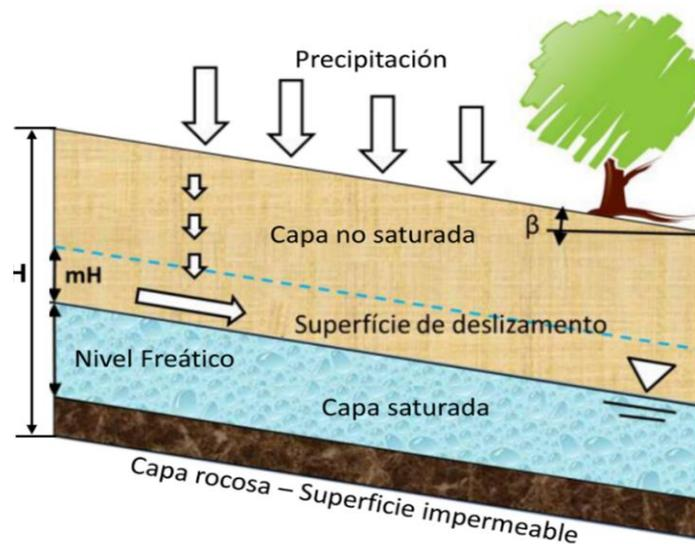
Figura 2-2 Esquema representativo para el modelo de estabilidad de laderas.
