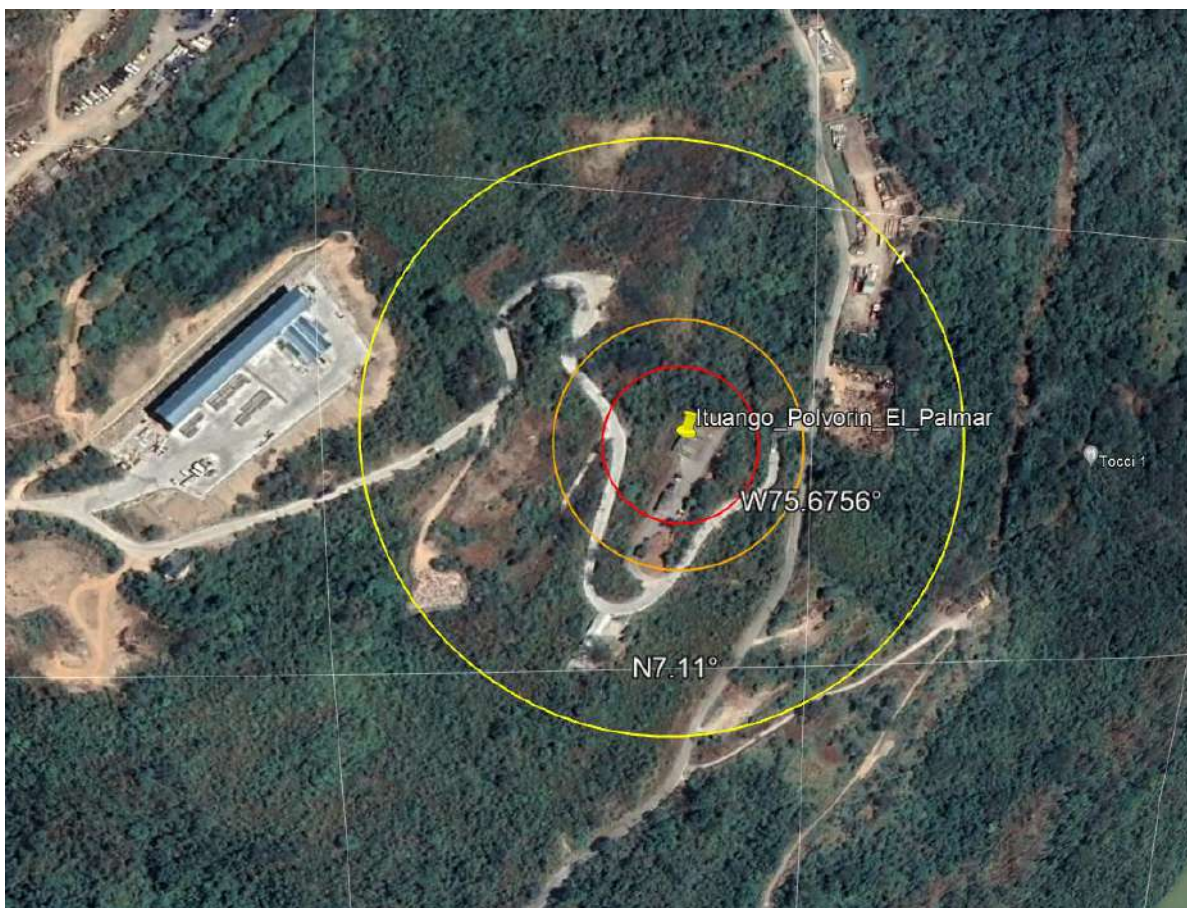
Figura 2-253 Radio de afectación por sobrepresión – Zona A Polvorín El Palmar. Fuente: Integral S.A., 2022.
