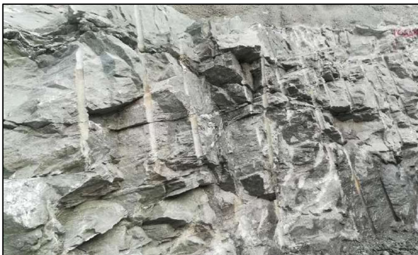
Figura 2-126 Macizo rocoso correspondiente a neis cuarzo-feldespático (Horizonte IIB) en la cota 211,0 m.s.n.m. y la abscisa 652,0 en el cuenco del vertedero.
