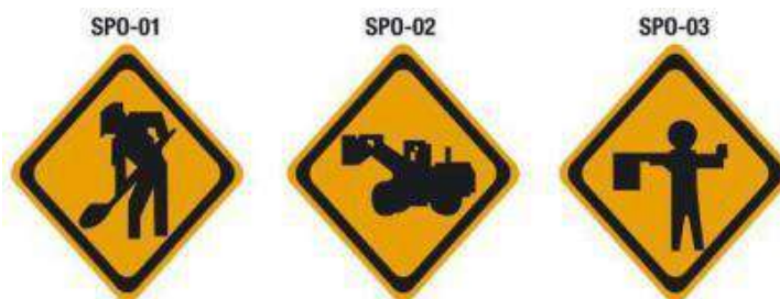
Figura 7.2.19 Señales preventivas, trabajos en las vía (SPO-01) – maquinaria en la vía (SPO-02) – banderero (SPO-03)
