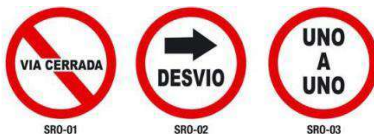
Figura 7.2.20 Señales reglamentarias en obra
