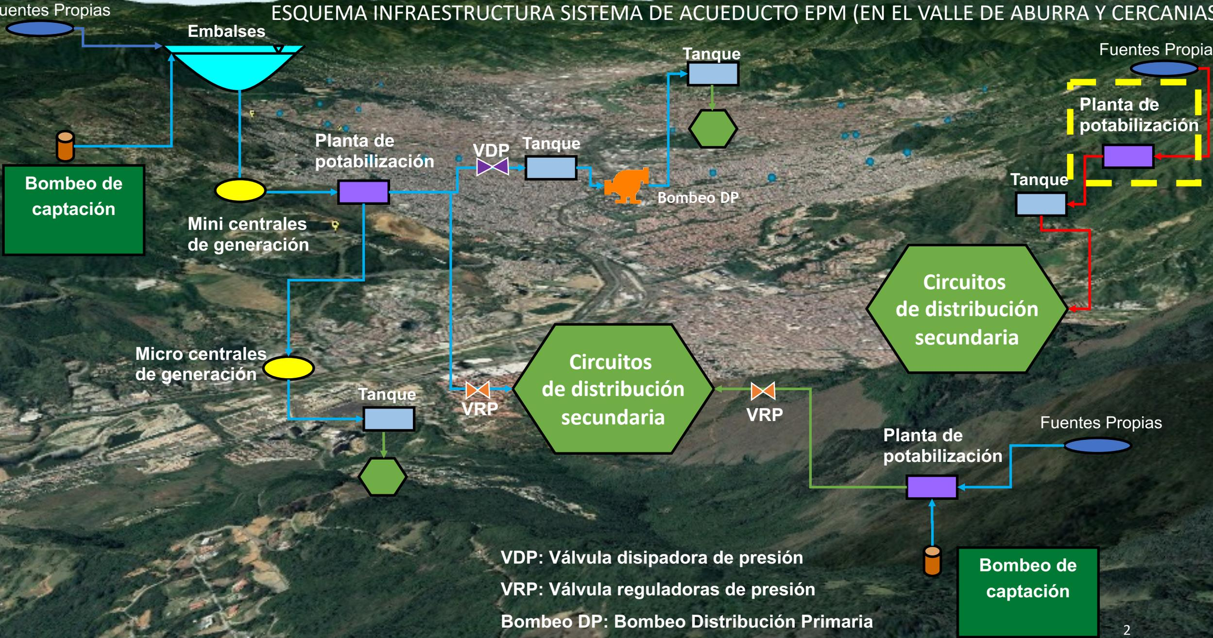
VDP: Válvula disipadora de presión
