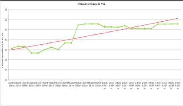
Figura 3 Infiltraciones sector izquierdo presa
