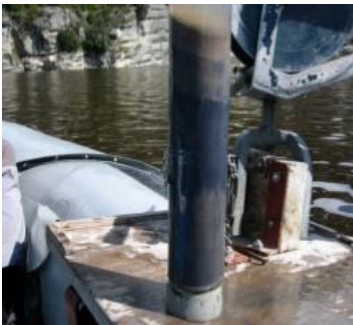
Toma de muestras de sedimento
