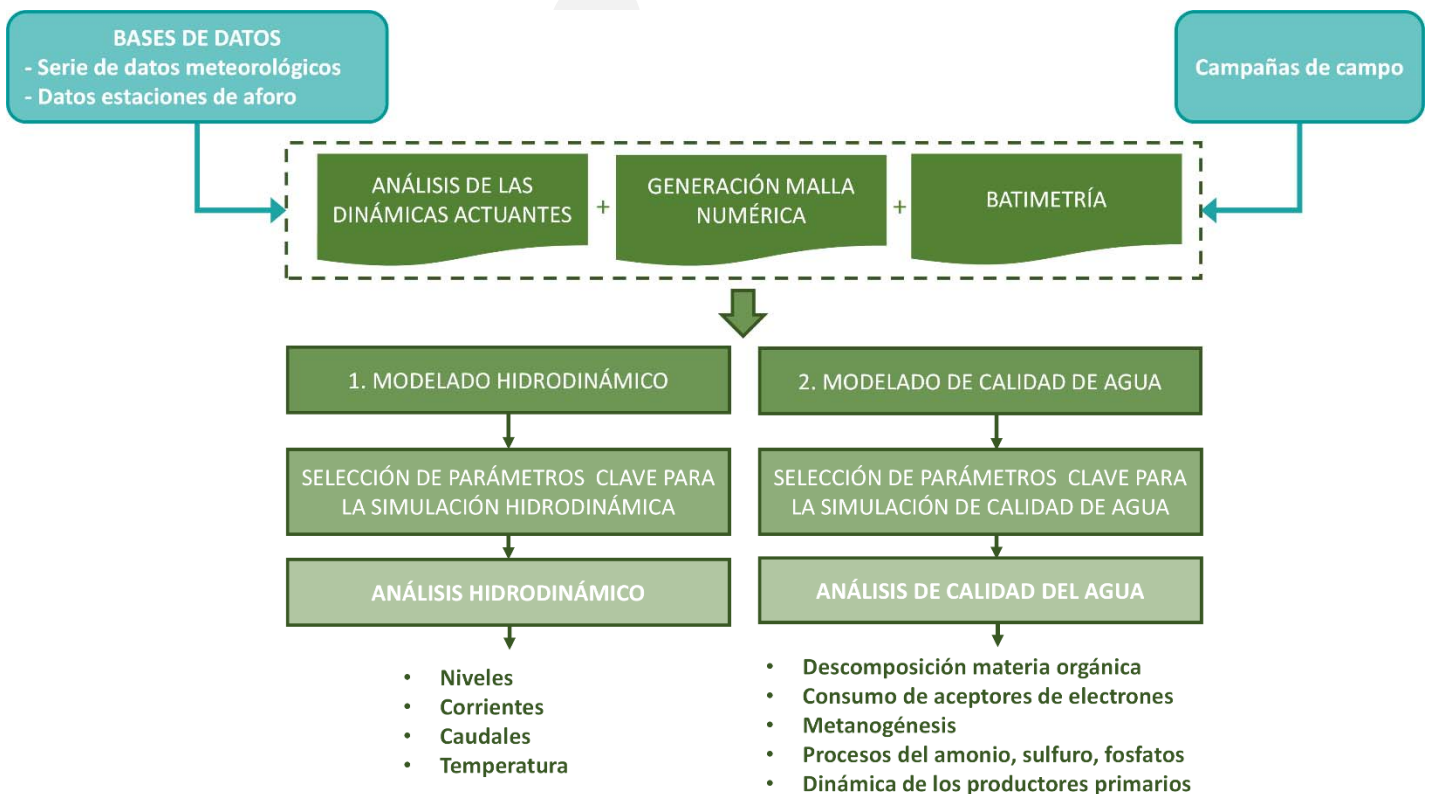
Figura 9. Descripción de los diferentes pasos para el análisis de la situación actual del río Cauca en el marco del proyecto: Implementación de un modelo de calidad de aguas en el Proyecto Hidroeléctrico de Ituango.
