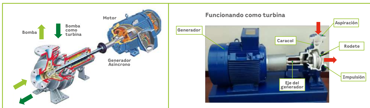
Figura 1. Esquema de un sistema Bomba como Turbina (PAT), con partes constitutivas. Tomado de: (Ortiz, 2008; Pérez et al., 2020).
