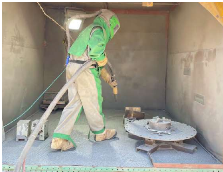
Figura 10. Proceso sandblasting o arenado.
