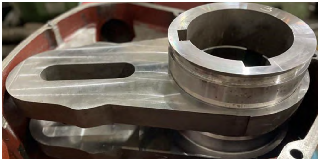
Figura 7. Reconstrucción final biela.
