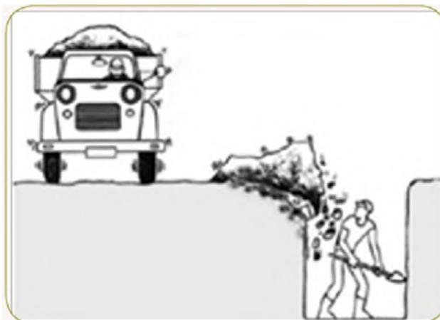
**Figura 4.** Accidentes de obra en excavaciones a cielo abierto. Recuperado de: (Ministerio del trabajo, 2014).
