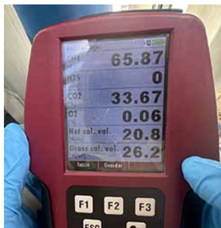
Figura 6. Medición de H_2S a la salida de filtros.
