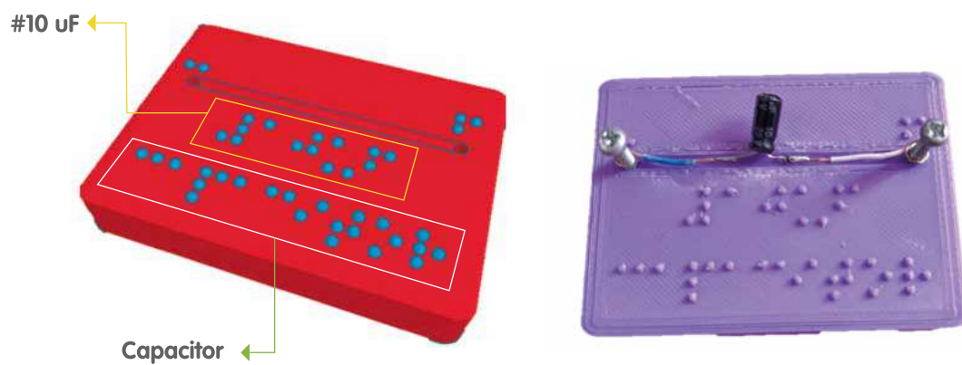
Figura 16. Base con marcación braille para capacitor electrolítico de 10uF.
