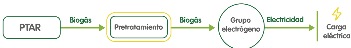
Figura 3. Aprovechamiento de Biogás para electricidad.
