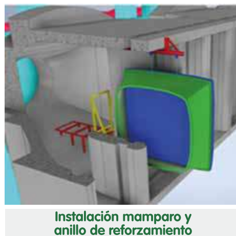
Figura 5. Instalación subacuática mamparo mecánico. Recuperado de: (DCN Diving BV, 2021)
