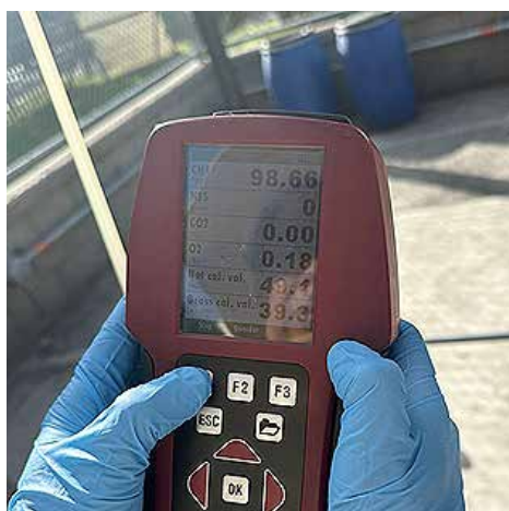
Figura 7. Parámetros medidos a la salida de la unidad PSA.
