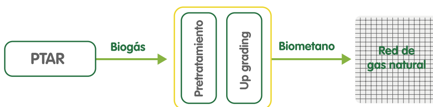
Figura 4. Esquema de inyección de biometano a red de gas natural.
