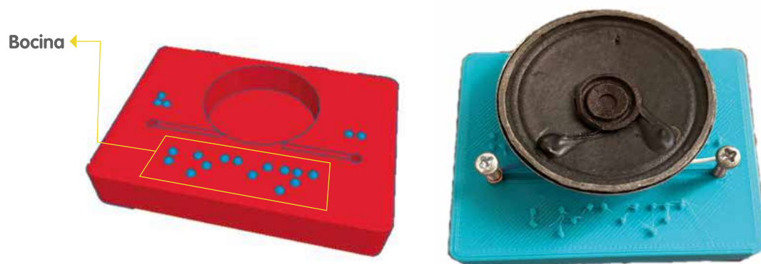
Figura 18. Base con marcación braille para bocina.
