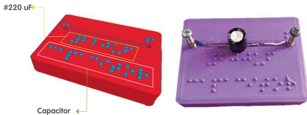
Figura 17. Base con marcación braille para capacitor electrolítico de 220uF.
