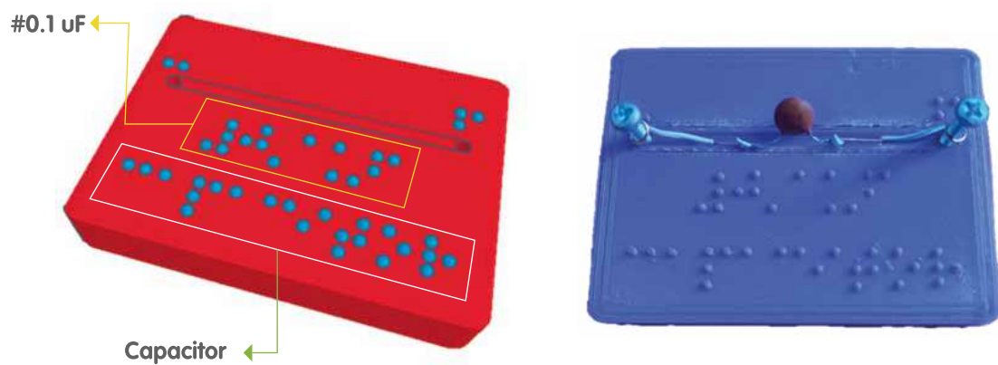
Figura 15. Base con marcación braille para capacitor de 0.1uF.
