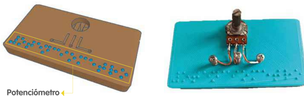
Figura 12. Base con marcación braille para potenciómetro.
