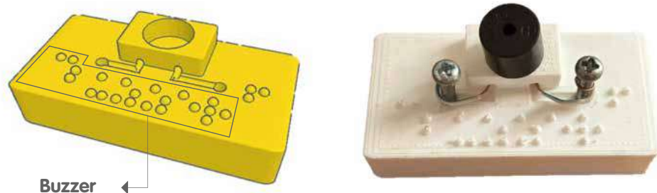
Figura 11. Base con marcación braille para buzzer.
