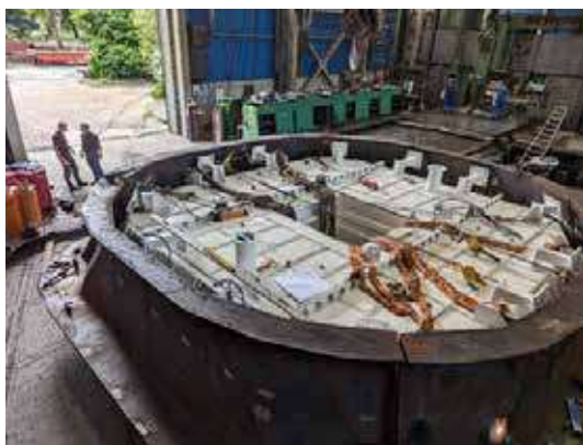
Figura 3. Mamparo mecánico 3. Armado y verificación alineamiento. Conjunto general.
