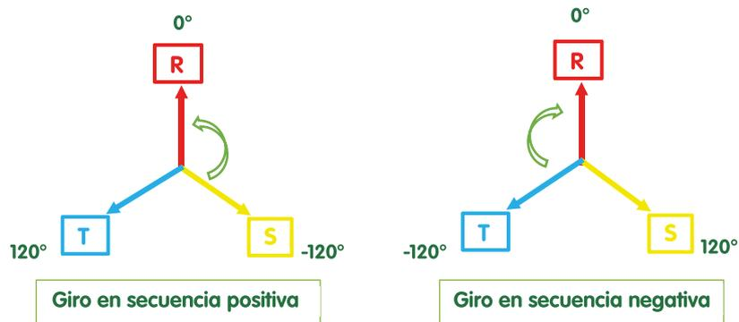
**Figura 3.** Esquema de giro en secuencia positiva y negativa.
