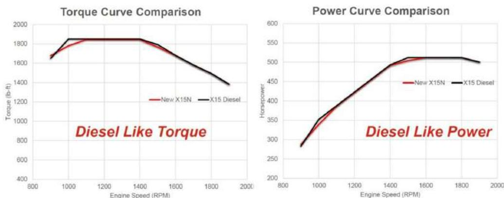
**Tabla 1.** Comparación de curvas de potencia y torque del motor Cummins X15 Diesel y Cummins X15N de gas natural. Recuperado de (Park, 2022).
